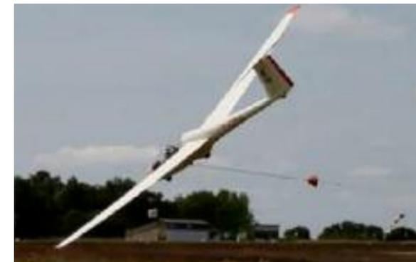
possible de lâcher la poignée jaune. Le risque d'une fausse manoeuvre de la part d'un élève reste minime, avec un largage intempestif alors que l'attelage est encore en phase d'accélération au sol. Pour les pilotes d'avions-remorqueurs fortement motorisés (exemple : Piper PA-25 Pawnee), une attention particulière doit être développée lors de décollage avec un planeur à crochet décalé de l'axe longitudinal, surtout sur herbe haute et par vent fort de travers. ■
