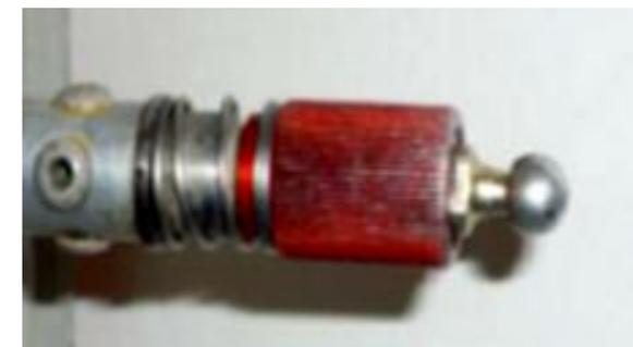
Les nouvelles rotule L'Hotellier sont livrées avec une broche sur le dessus de la rotule qui devient visible à l'extérieur de la douille, une fois que la rotule et la douille sont correctement engagées. La goupille permet également une inspection tactile. La connexion doit encore être sécurisée.
