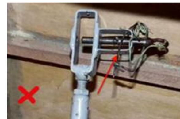
La connexion n'était pas sécurisée. L'aiguille de sécurité ne passait que par un seul trou du support, mais pas non plus par l'axe et le trou inférieur du support. De cette façon, l'axe peut se déplacer librement et le raccord de commande peut se déconnecter.
