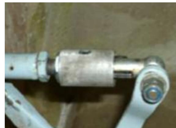
La douille Uerlings et la douille filetée similaire utilisées sur les planeurs LS tournent ou se dévissent au-dessus de l'accouplement et ne peuvent pas être mis en place si la rotule et le support ne sont que partiellement engagés.
