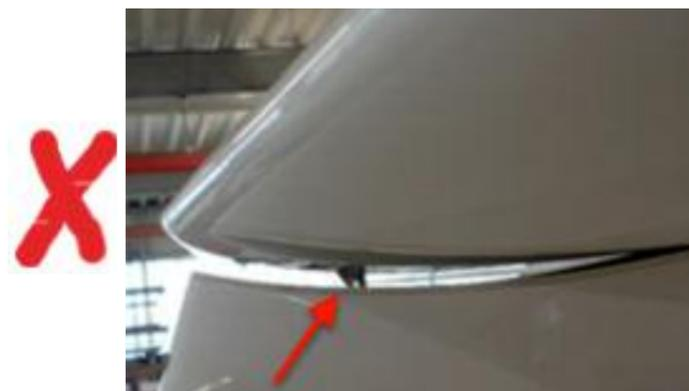
Le plan fixe est positionné sur son point d'attache arrière mais pas à l'avant
