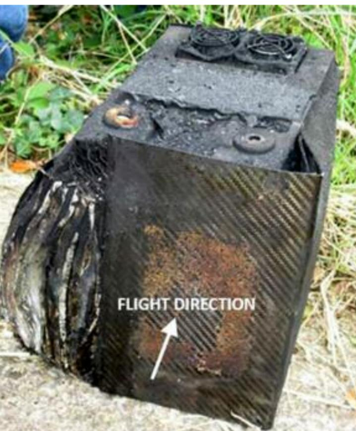
**Les dommages causés par l'incendie au pack de batteries placé le plus vers l'avant du planeur.**
