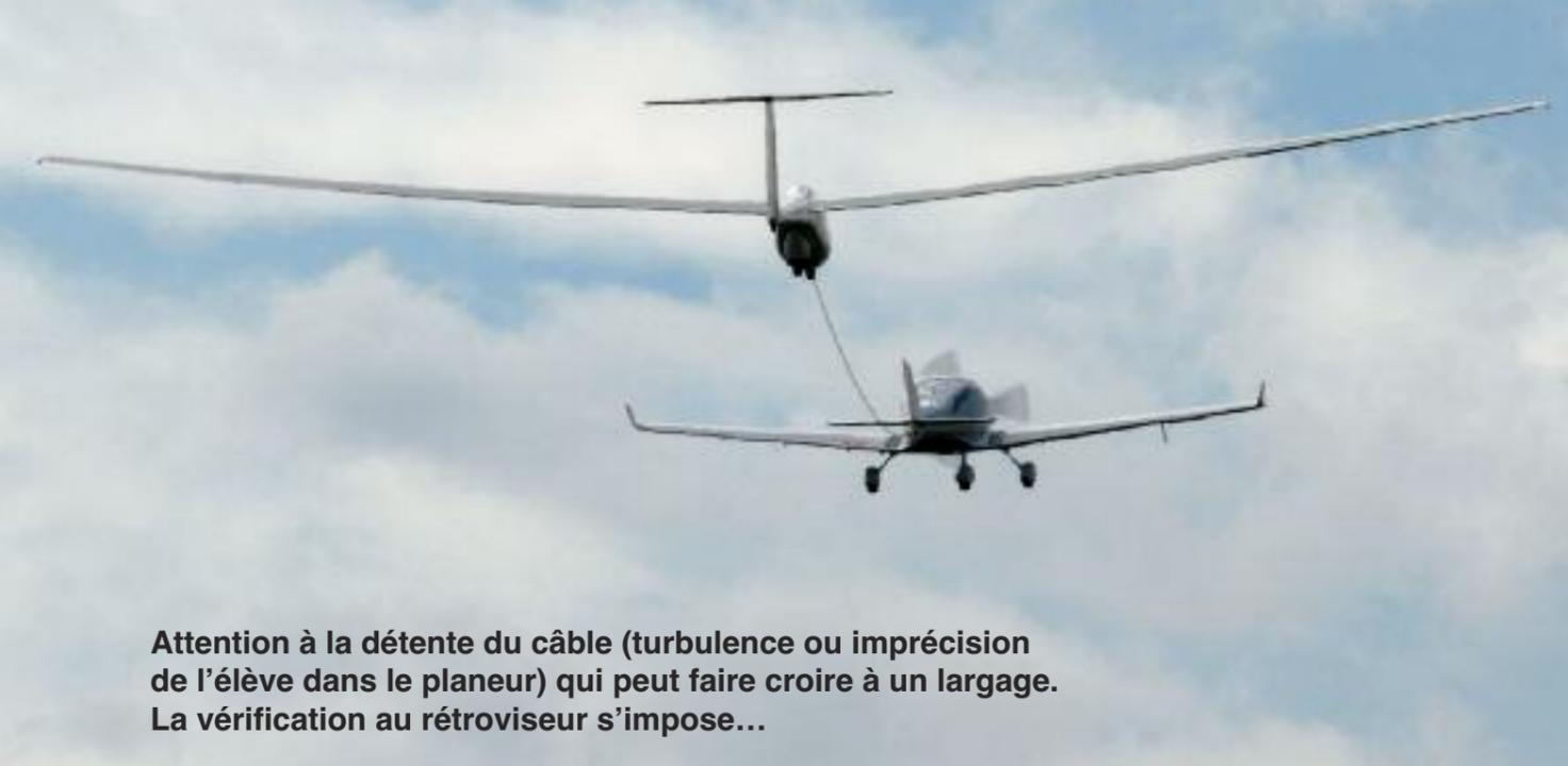
**Attention à la détente du câble (turbulence ou imprécision de l'élève dans le planeur) qui peut faire croire à un largage. La vérification au rétroviseur s'impose...**
