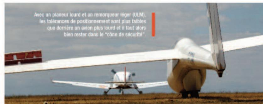
Avec un planeur lourd et un remorqueur léger (ULM), les tolérances de positionnement sont plus faibles que derrière un avion plus lourd et il faut alors bien rester dans le "cône de sécurité".
