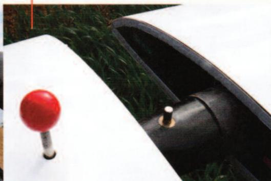
Le contrôle des épingles de sécurité ne doit pas être négligé.
