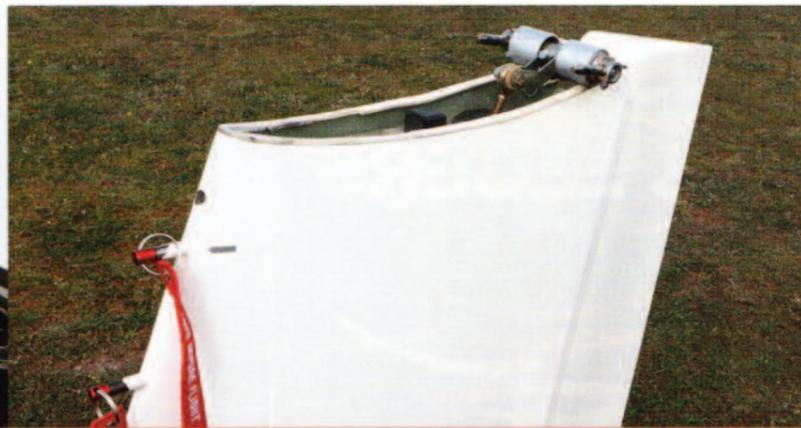
La mise en place du plan fixe reste cruciale. Un contrôle par deux personnes est recommandé.
