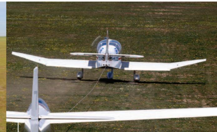
Le planeur est sur son train principal, le contrôle latéral bien acquis. Il est temps de lâcher la poignée jaune. Si besoin, il est possible d'ajuster les volets si votre planeur en dispose.
