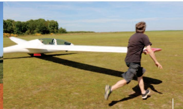
L'aide en bout d'aile vient de lâcher l'aile. C'est la zone "critique" où il faut garder la main sur la poignée jaune tant que l'on n'a pas acquis et confirmé le contrôle latéral du planeur.
