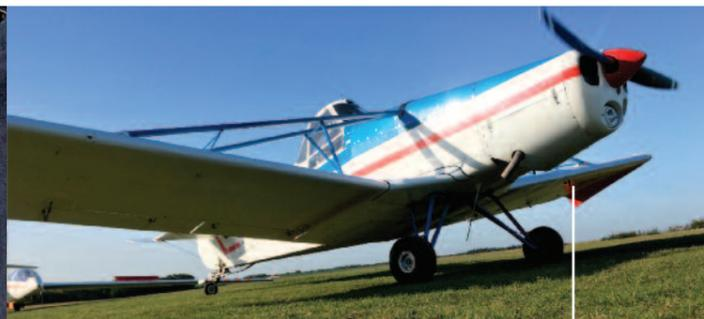
Un remorqueur puissant pouvant rapidement donner de l'énergie à l'attelage, une herbe trop haute pouvant bloquer un saumon d'aile au sol, un vent fort générant de la portance sur les ailes du planeur très rapidement... autant de paramètres favorables à la mise en place d'un cartwheel. La parade : la main gauche sur la poignée de largage.
